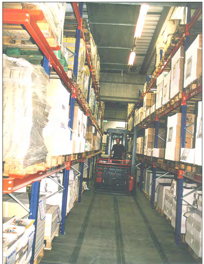
Das Hochregallager mit einem Schmalgangstapler hat eine zentrale Funktion im JOTA-LLS bei Konradin Druck.
