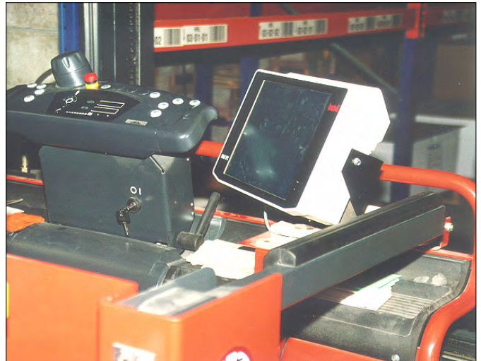
Datenfunkterminal mit Barcode-Scanner auf dem Stapler erlauben die beleglose Abwicklung sämtlicher Materialbewegungen.
