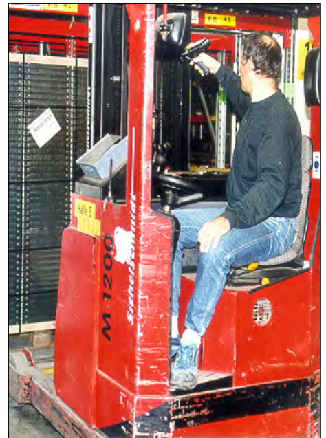
Vom Stapler aus werden per Datenfunk die Ein- und Auslagerungsvorgänge elektronisch erfasst.
